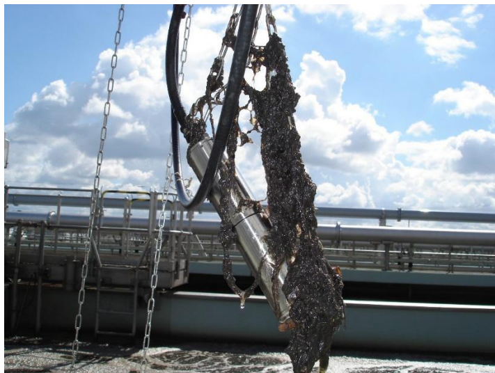
ISA 光谱水质传感器在污水池中监测
