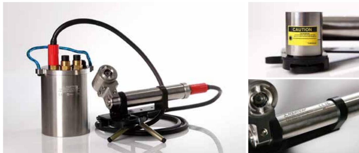
Aquation的Shutter Fluorometer全自动植物荧光监测系统可以同时测量光化学系统PS II的光化学效率及最大光化学量子效率。采用全球首创的“快门”结构使监测样本交替地处于光照和黑暗状态，无需人工干预地完成整个光淬灭分析。灵活的软件系统允许您设定快门自动开闭时间。
