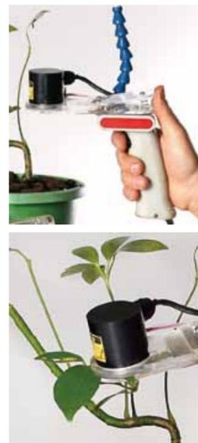
Aquation的Handheld Fluorometer手持式荧光测量仪及便携式数据采集器专为野外植物荧光测量而设计（比如测量植物胁迫，最大光化学量子效率， $\Phi_{PSII}$ ）。手持式的结构允许您单手操作完成多个样本的测量，测量结果可以实时查看或导出至电脑进行分析。
