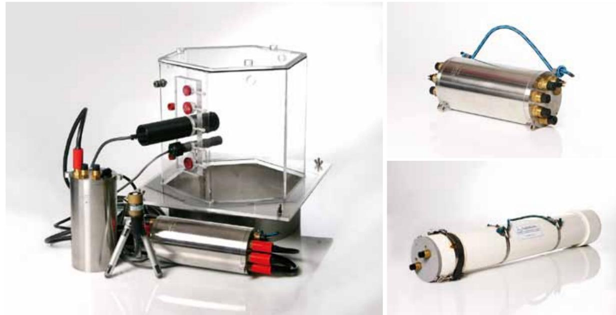
Aquation的Respirometer水下两用光合呼吸测定系统可以原位测量陆地与水生生物群落的代谢速率。Respirometer通过监测溶解氧浓度，温度和辐射值（PAR）来计算代谢速率，可以连续工作长达24个小时，同时可选监测荧光 $\Phi_{PSII}$ 和pH值。
