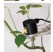
Aquation的Handheld Fluorometer手持式荧光测量仪及便携式数据采集器专为野外植物荧光测量而设计(比如测量植物胁迫,最大光化学量子效率, $\phi_{PSII}$ )。手持式的结构允许您单手操作完成多个样本的测量,测量结果可以实时查看或导出至电脑进行分析。
