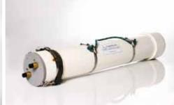
Aquation的Respirometer水下两用光合呼吸测定系统可以原位测量陆地与水生生物群落的代谢速率。Respirometer通过监测溶解氧浓度,温度和辐射值(PAR)来计算代谢速率,可以连续工作长达24个小时,同时可选监测荧光φ<sub>PSII</sub>和pH值。
